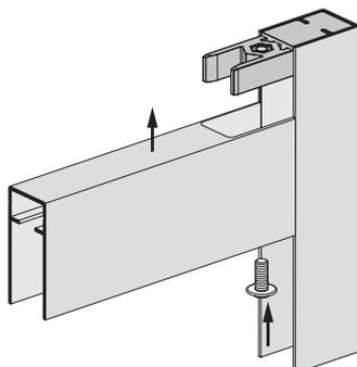
So kann z.B. das Plissee problemlos zwischen Tür (Fenster) und Rollladenführungsschiene montiert werden (Platzbedarf 23 mm).
