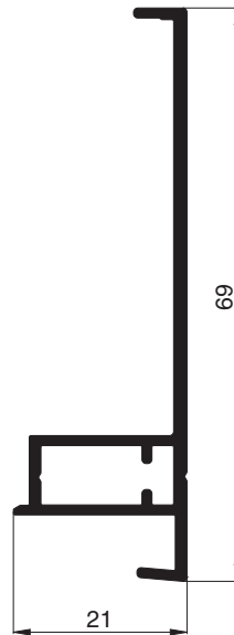
10 44 15 Abdeckprofil seitliche Führungsschiene breit
