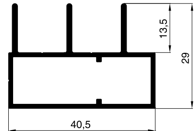
10 48 31 Laufschiene 3-fach seitlich / oben / unten
