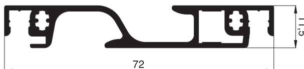
10 34 13 Sprossenprofil mit beidseitiger Griffleiste
