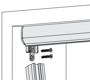
So kann z.B. das Rollo problemlos zwischen Fenster und Rolladenführungsschiene montiert werden (Platzbedarf 40 mm).
