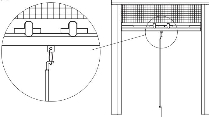
Als einfache Alternative zum Bedienstab kann die Gewebeschiene zusätzlich mit einer Ziehschnur ausgestattet werden.
