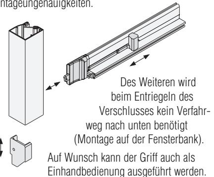
Des Weiteren wird beim Entriegeln des Verschlusses kein Verfahren nach unten benötigt (Montage auf der Fensterbank). Auf Wunsch kann der Griff auch als Einhandbedienung ausgeführt werden.
